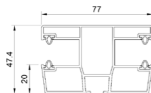
Doppel Führungsschiene (PVC) - RS Revision von innen. MK939
