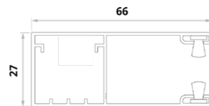
Einseitige Führungsschiene (für H55 Lamellen). PP6600
